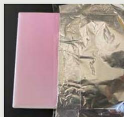
一部分に光が当たらないように隠し、室内灯に当てて光触媒反応をさせる。
